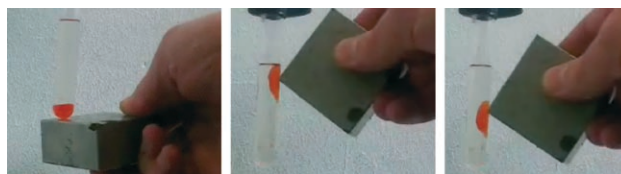
Abbildung 1. Reaktion der orangefarbenen ionischen Flüssigkeit 1 auf einen Neodym-Magneten.
